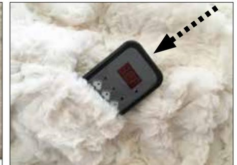
Abbildung 14: Bedienteil durch Öffnung schieben
